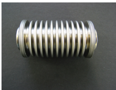
Solfangerforbindelse, hydraulisk Forbinder to solfangere og kompenserer for de termiske udvidelser i længden
